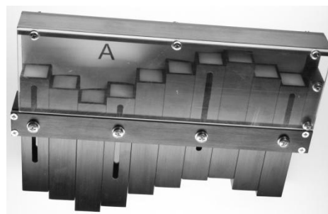
Obr. 7.2 Laditelný model vokálního traktu ve výchozím stavu a nastaven na samohlásku A
