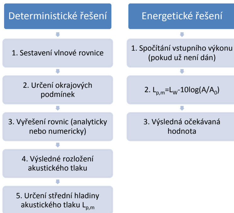
Obr. 2 Rozdíly v základních algoritmech deterministického a energetického řešení vibroakustických problémů
