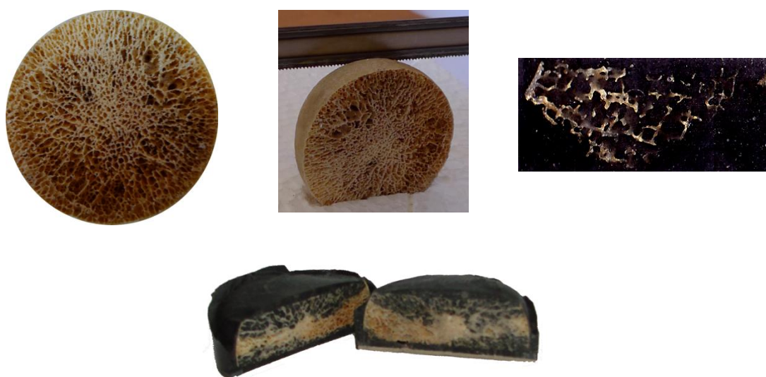
Obr. 11.6: Vzorek kosti před a po zalití epoxidem
