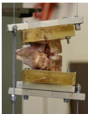
Obr. 11.2: Segmenty páteře prasate s aplikovaným fixátorem.
