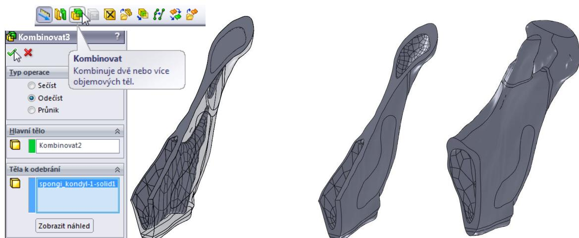
Obr. 3.79 Odečtení jednotlivých modelů.
